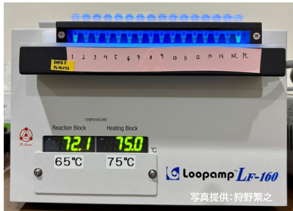
フィリピン・パラワン島の住民検体を、Malaria-LAMPを用いて検査：陽性検体（No.1）。装置表示温度（Reaction Block側）は酵素失活プロセス中の反応槽温度
