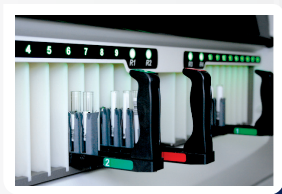
検体ラックおよび試薬ラックセットエリア
