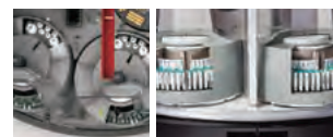
2ロードステーション 2ドア 84 検体 試薬 : 3mL : 66バイアル 10mL : 36バイアル 12希釈トレイ
